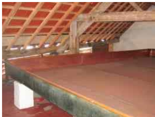
Figur 2. Svalefade, som dette på Cantillions bryggeri i Brussel, Belgien er I årevis blevet brugt til at køle urten og fjerne trub'en, der bundfældes under sit 1 – 3 timers hvil.
