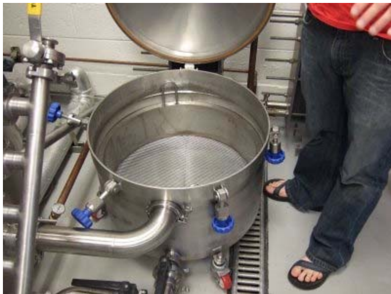
Figur 1. Hop back, det traditionelle værktøj til at fjerne trub, omfatter en falsk bund, der holder et filterdannende lag humle. Varm urt lukkes ind gennem åbningen i toppen og går ud af afløbet i bunden.
